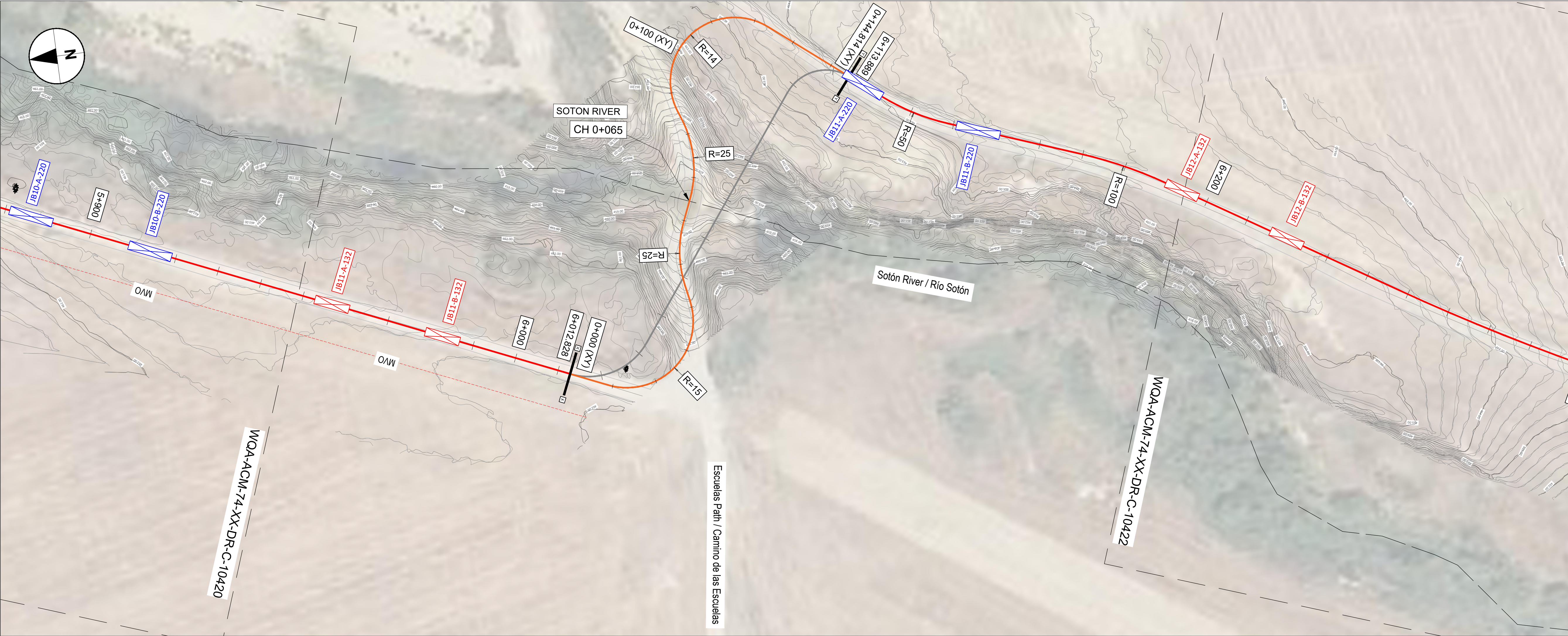
DETAIL 1: HIGH VOLTAGE TRENCH UNDER LAND AREA (2x220kV + 2x132kV CABLES) / DETALLE 1: ZANÍA LÍNEA ALTA TENSIÓN BAJO TERRENO (2X220kV + 2X132kV CABLES)
