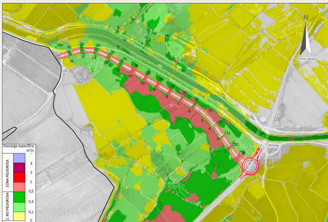
Figura 17. Estado propuesto: Crecida T500, zona Este. Cobertura de descarga esp.
