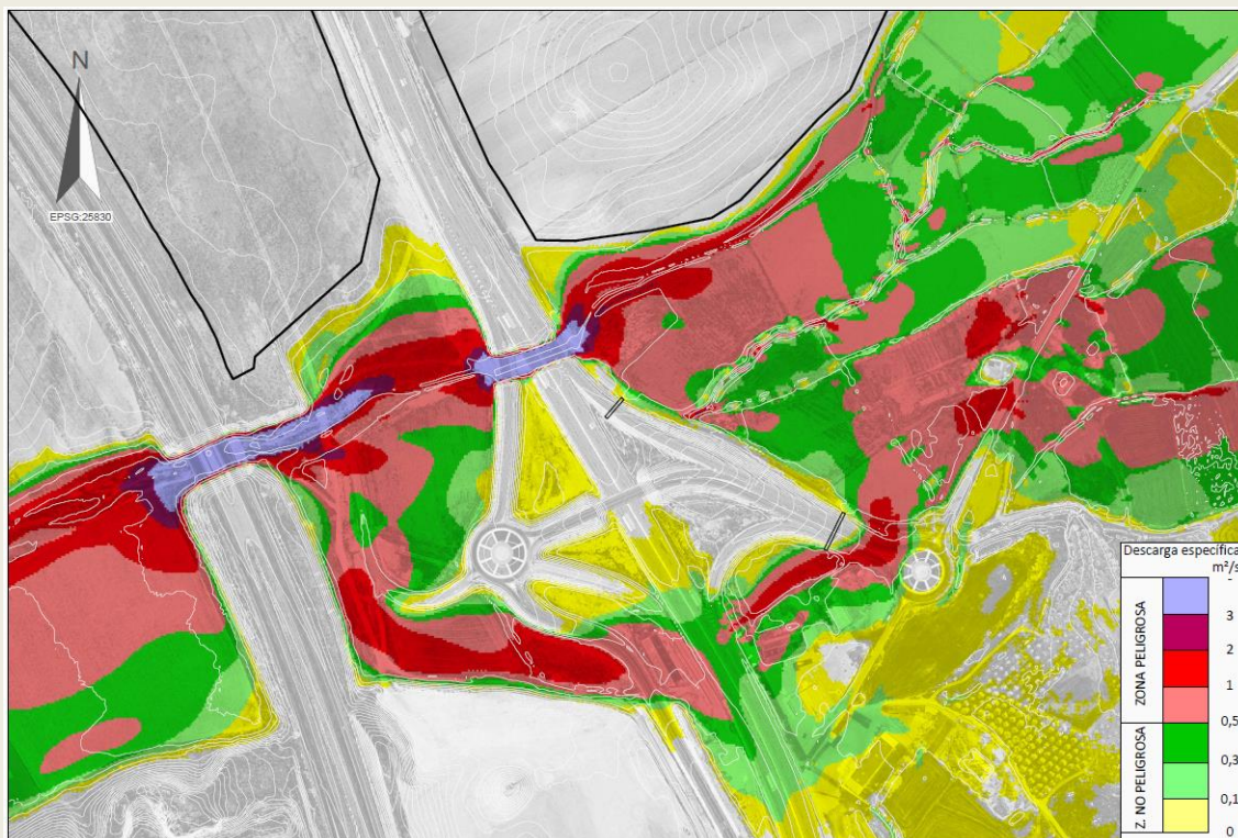
Figura 10. Estado actual: Crecida T100, zona Oeste. Cobertura de descarga específica
