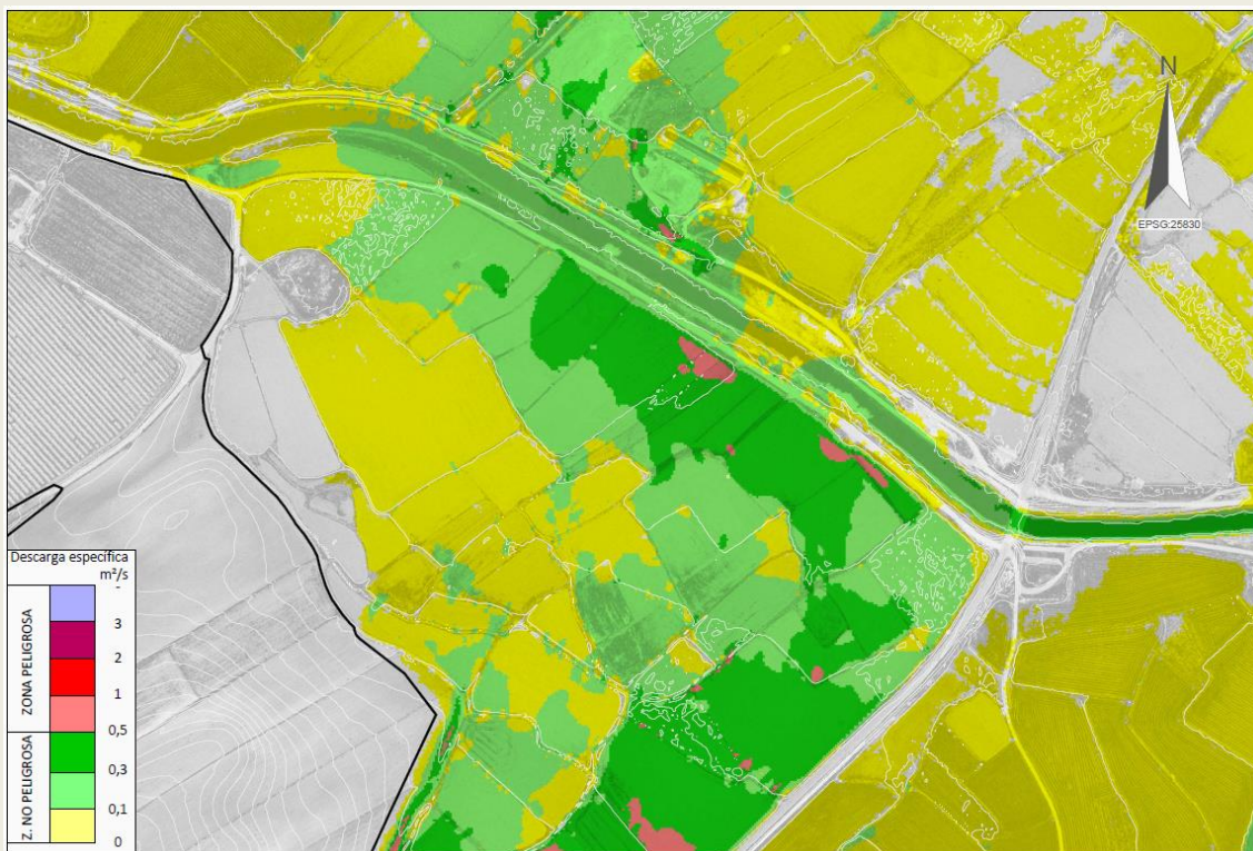
Figura 16. Estado actual: Crecida T500, zona Este. Cobertura de descarga específica
