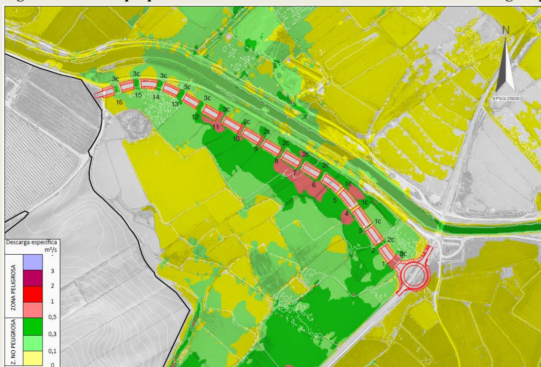
Figura 13. Estado propuesto: Crecida T100, zona Este. Cobertura de descarga esp.
