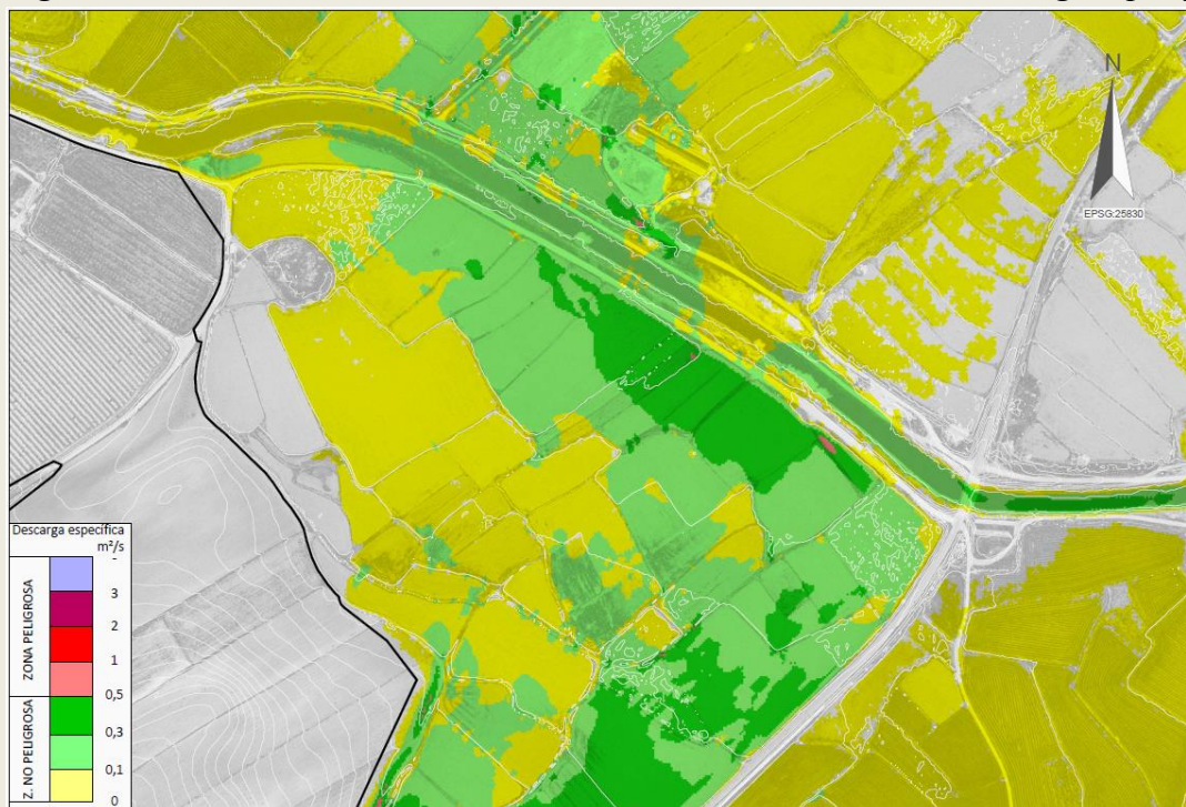
Figura 12. Estado actual: Crecida T100, zona Este. Cobertura de descarga específica
