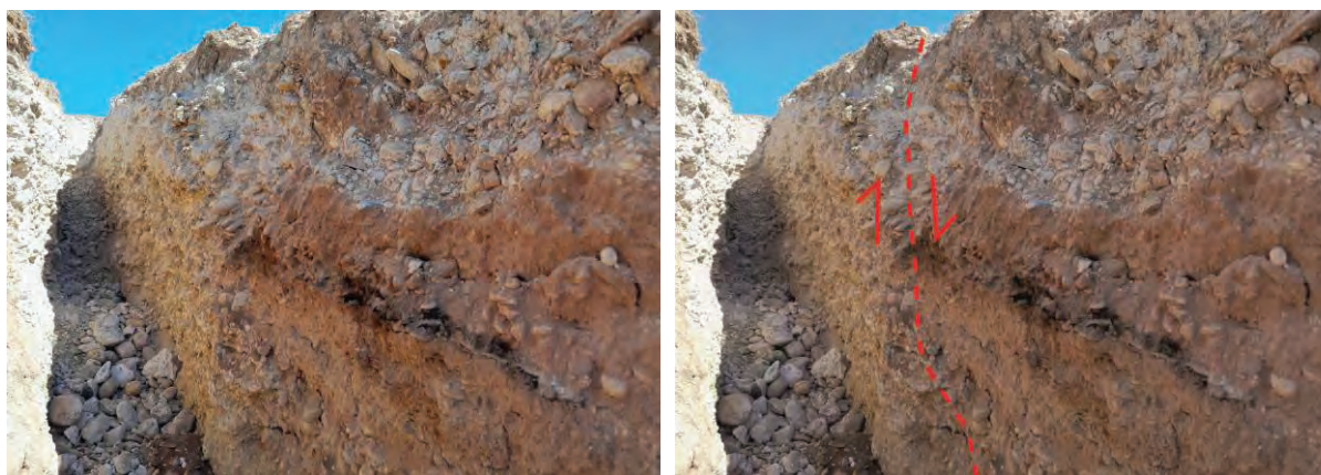
Figura 10. Plano de rotura y contacto mecánico entre las Unidades 1 y 2.
