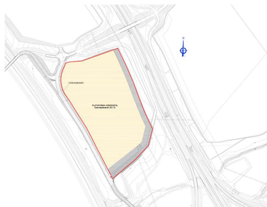
Ilustración 6. Detalle Plano 5.5.1 (planta de explanación en SP-3)
