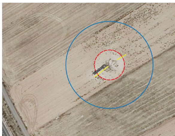
Ilustración 92. Posición de las trincheras. Límite de la dolina y distancia de seguridad (Fuente: Estudio Geotécnico)
