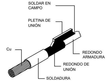
PIEZAS SOMBREADAS, REALIZADAS EN TALLER (PARA ADAPTAR LOS POSIBLES Ø DISTINTOS DE LA ARMADURA CON EL Cu)
