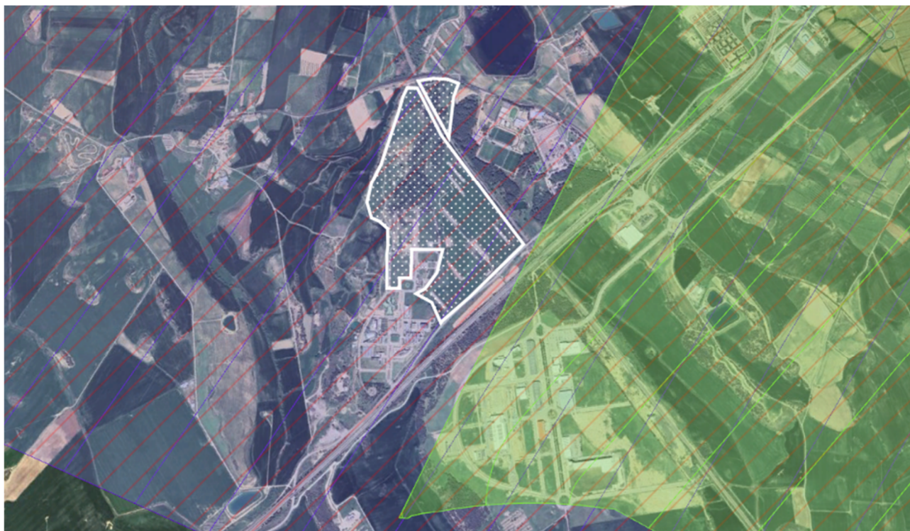
Ilustración 1. Ámbito del sector, servidumbres de la operación de aeronaves (verde) y Servidumbres PAPI (morado)
