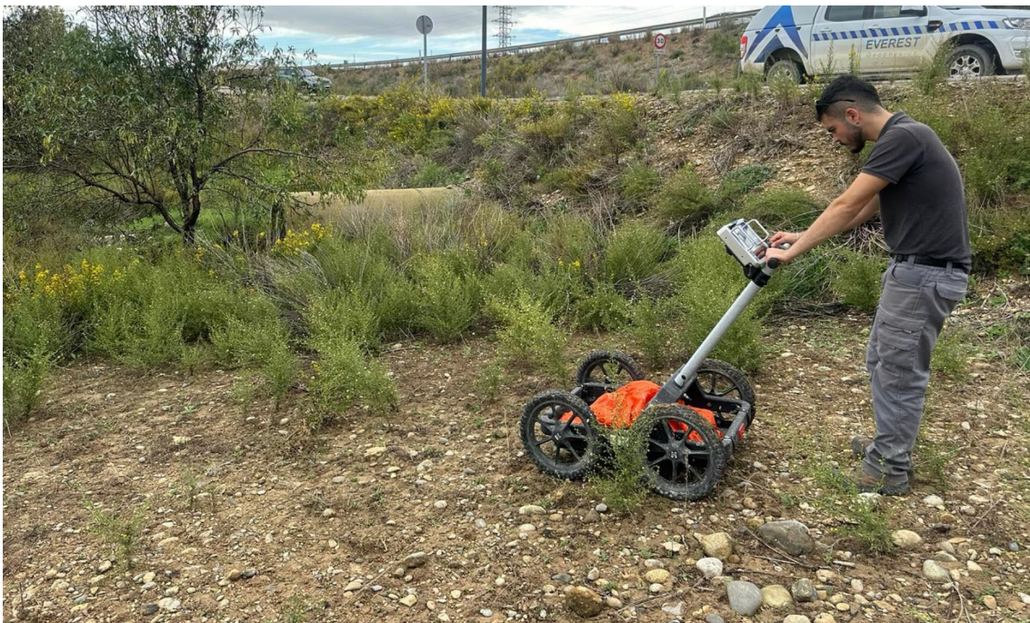
Figura 9. Operador geofísico realizando la adquisición de datos de georradar en uno de los puntos geotécnicos analizados.
