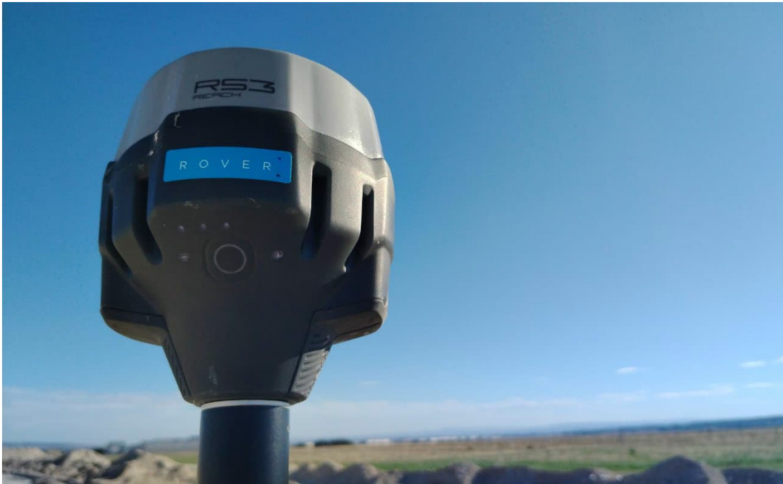
Figura 6. Receptor DGPS utilizado en este estudio.
