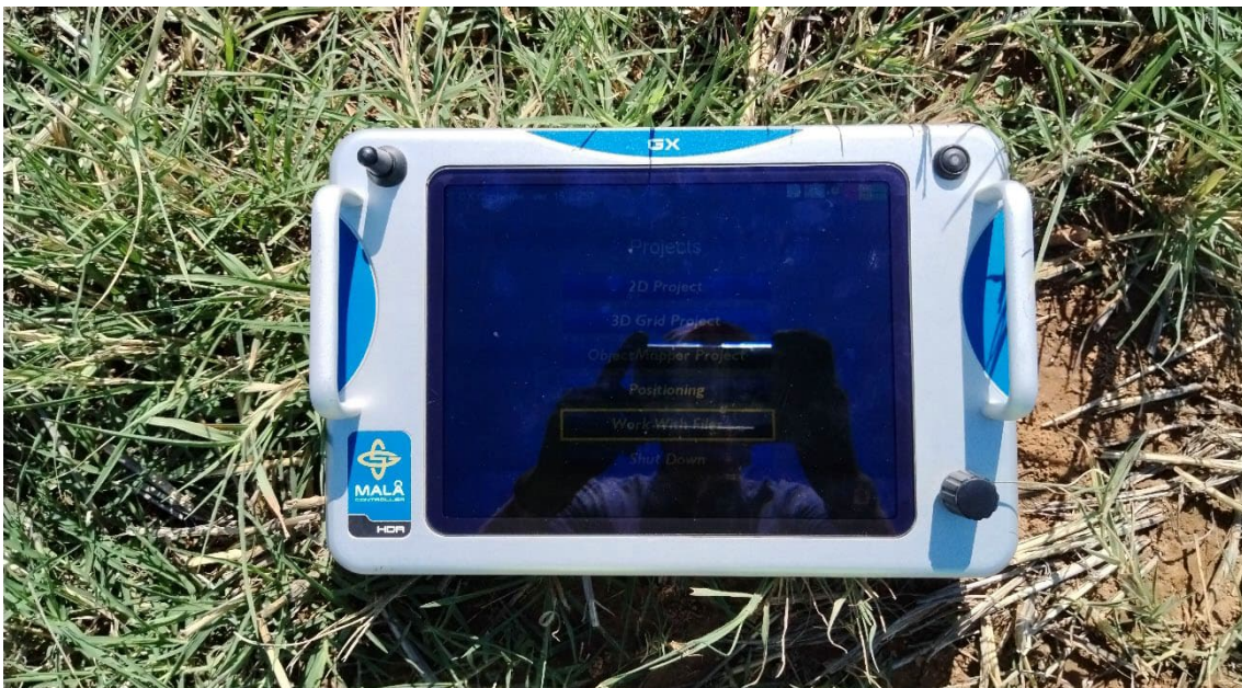
Figura 5. Unidad de control GX12 utilizada en este estudio.
