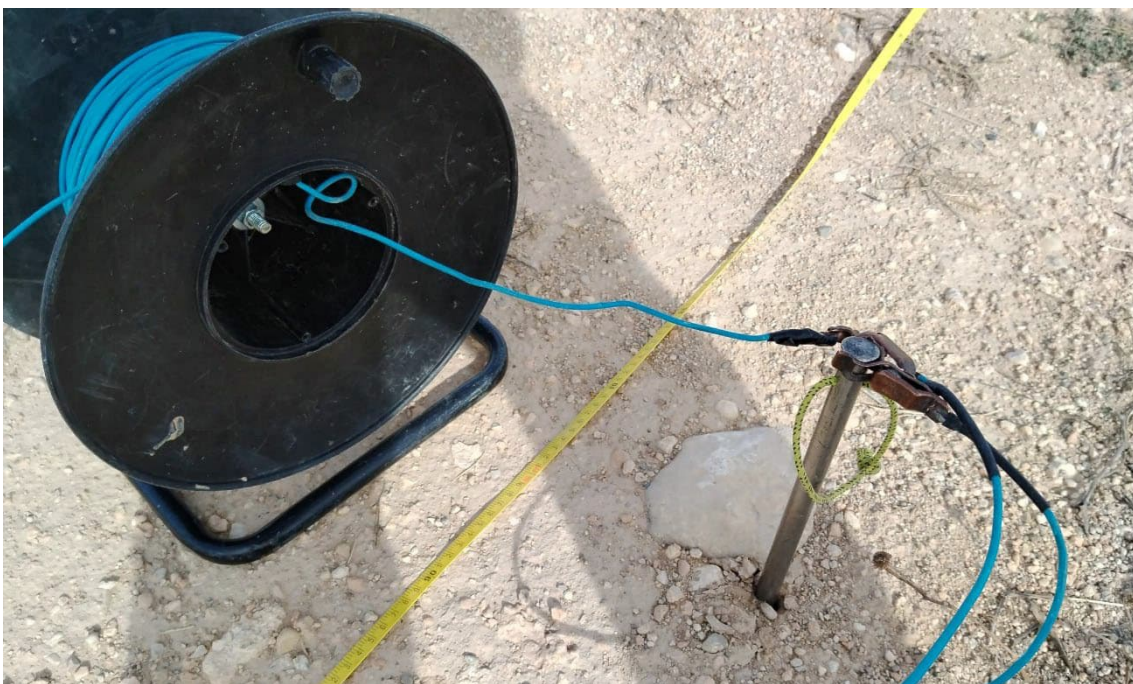
Figura 8. Detalle de un electrodo de acero en superficie conectado a la línea de corriente.
