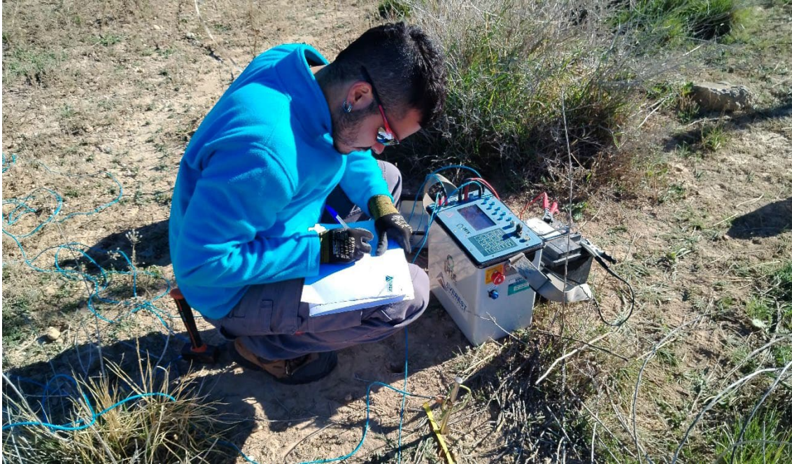
Figura 11. Adquisición de datos de uno de los SEV realizados en la zona de estudio.
