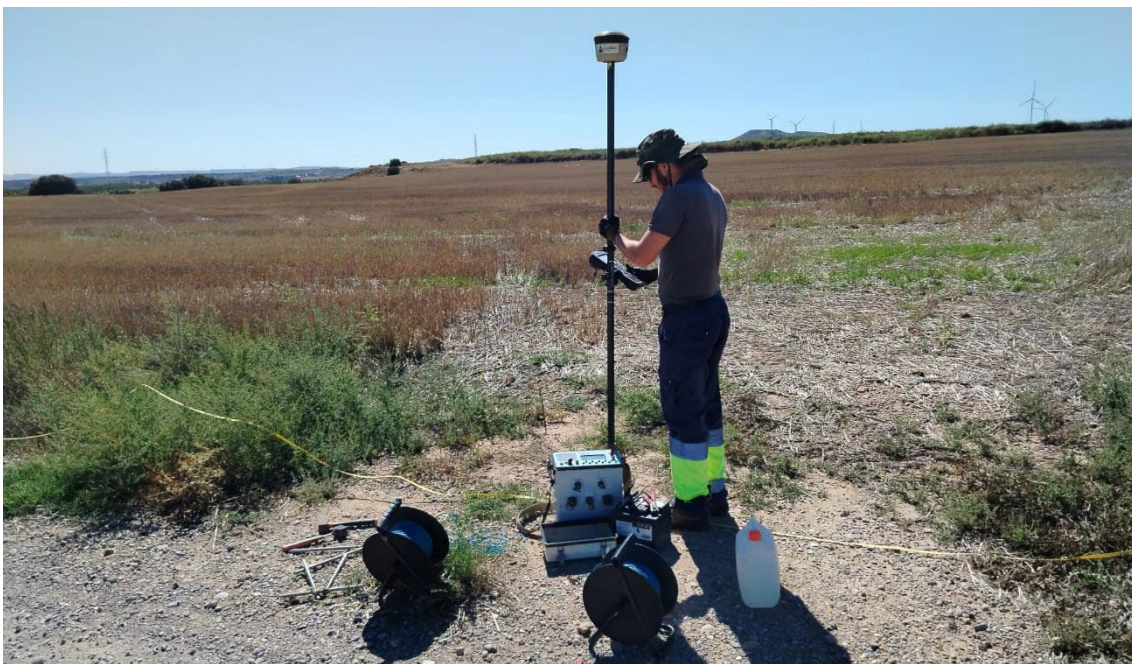
Figura 12. Especialista en métodos eléctricos tomando las coordenadas GPS de un SEV.
