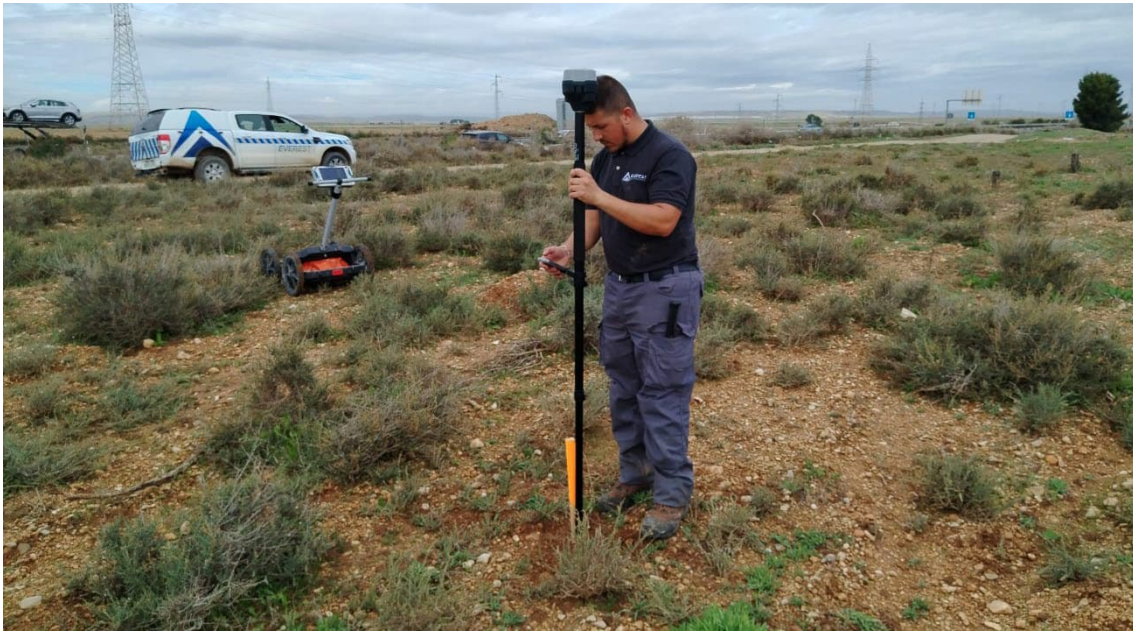
Figura 10. Georreferenciación de puntos geotécnicos con un DGPS.
