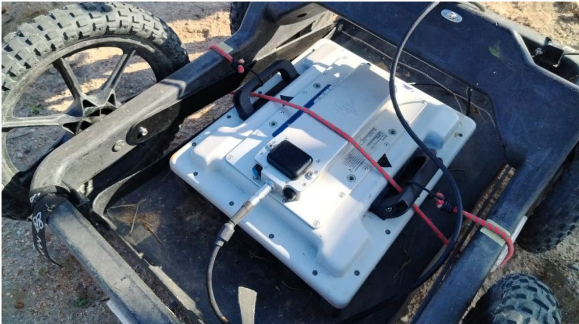
Figura 4. Antena GPR de 450 MHz y rueda instrumentada con un odómetro utilizada para la adquisición de datos en este estudio.
