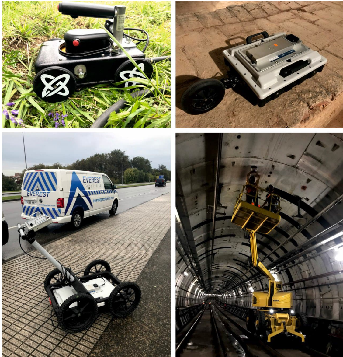
Figura A1-4. Diferentes tipos de modelos de GPR. Todos ellos tienen componentes similares (receptor y transmisor), cuentakilómetros, unidad de control y una pantalla de control.
