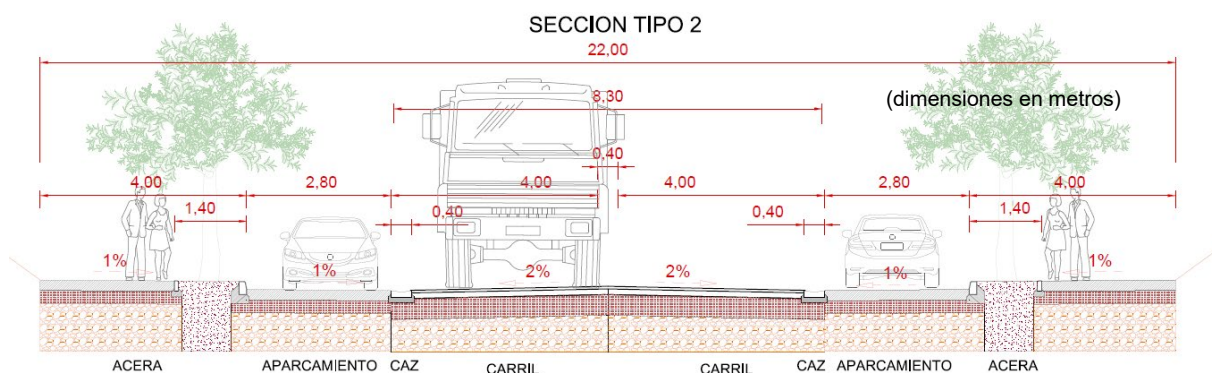
Ilustración 5. pendientes y dimensiones de componentes de la sección de vial tipo 2.
