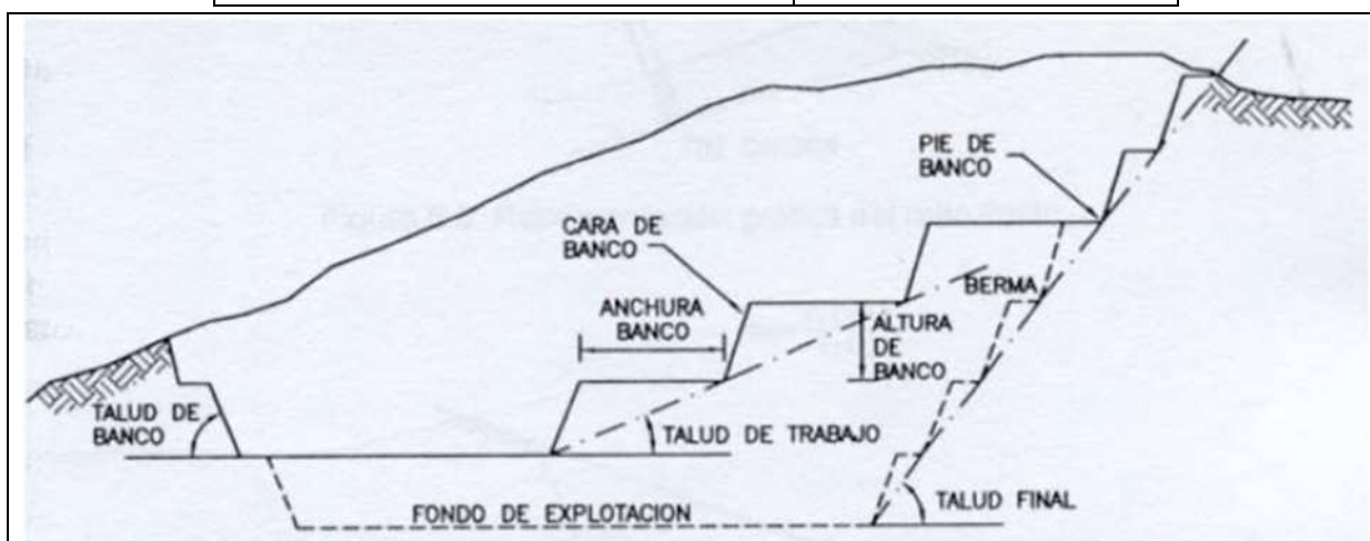
Gráfico nº 7.- Terminología utilizada en una mina a cielo abierto.
