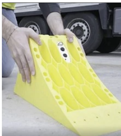
Figura 9.4: El calzo inteligente «SiChock» (fotografía propiedad de Signos IoT).
