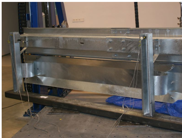
Figura 9.3: La barrera inteligente «Smart RRS» (fotografía propiedad de los autores).
