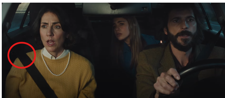
Figura 6.7: Cinturón de seguridad mal colocado.
