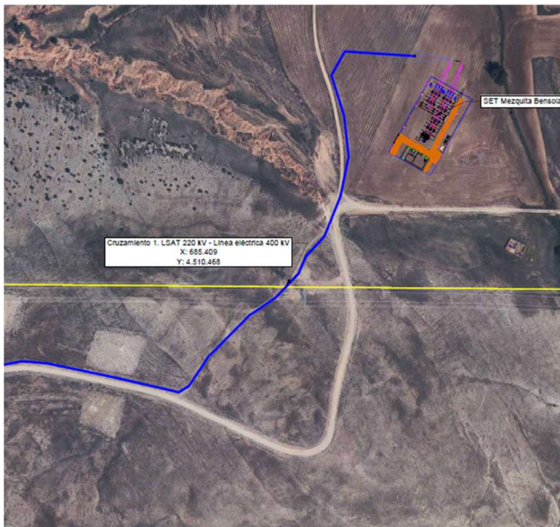
Ilustración 23. Afección a líneas eléctricas (1/3)
