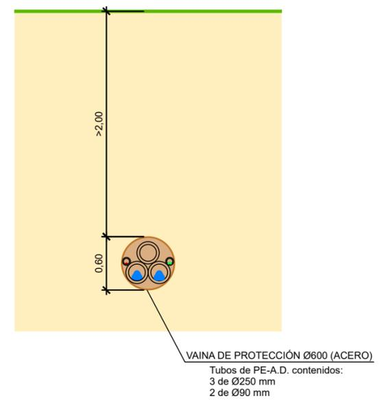
DETALLE DE FOSO DE ATAQUE PARA HINCA DE TUBO DE ACERO Ø < 800mm
