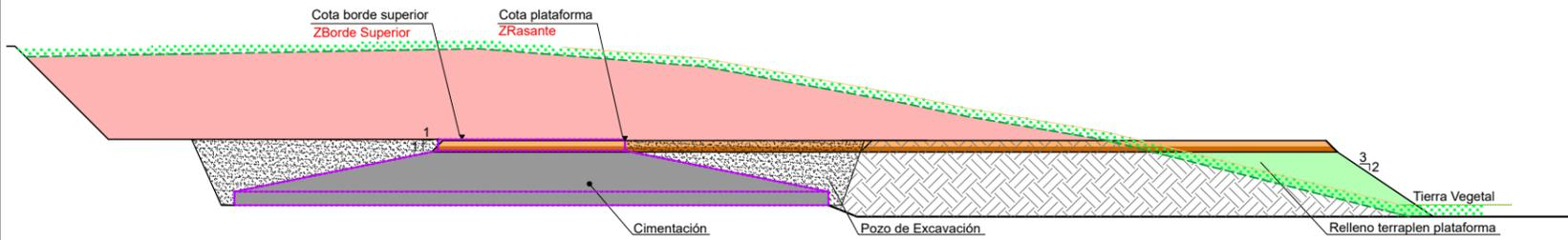
**SECCION B-B: PLATAFORMA DE MONTAJE**
