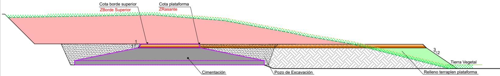
**SECCION B-B: PLATAFORMA DE MONTAJE**
