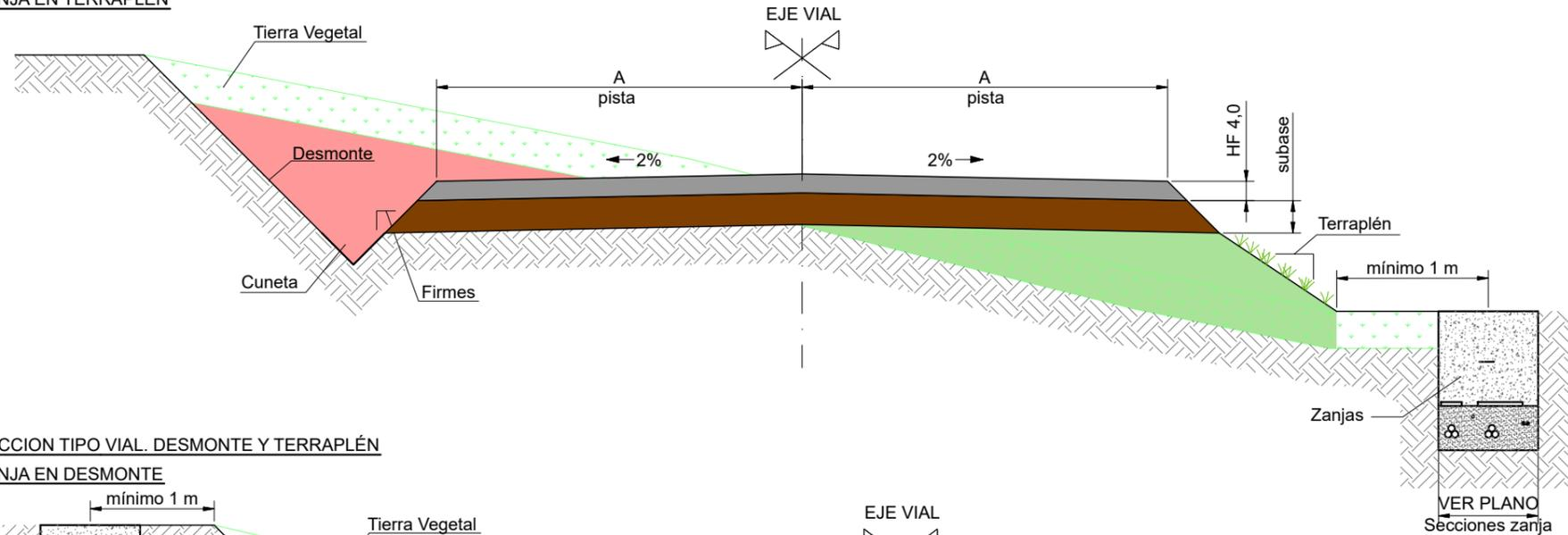
**SECCION TIPO VIAL. DESMONTE Y TERRAPLÉN**
