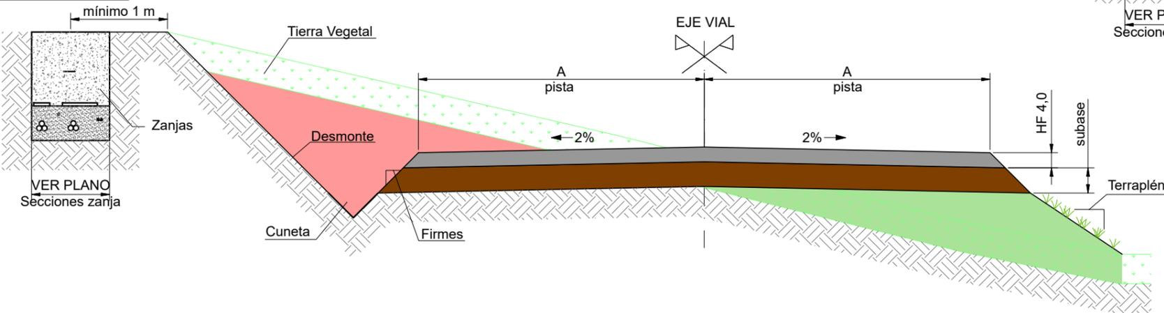
**SECCION TIPO VIAL. DESMONTE Y TERRAPLÉN**
