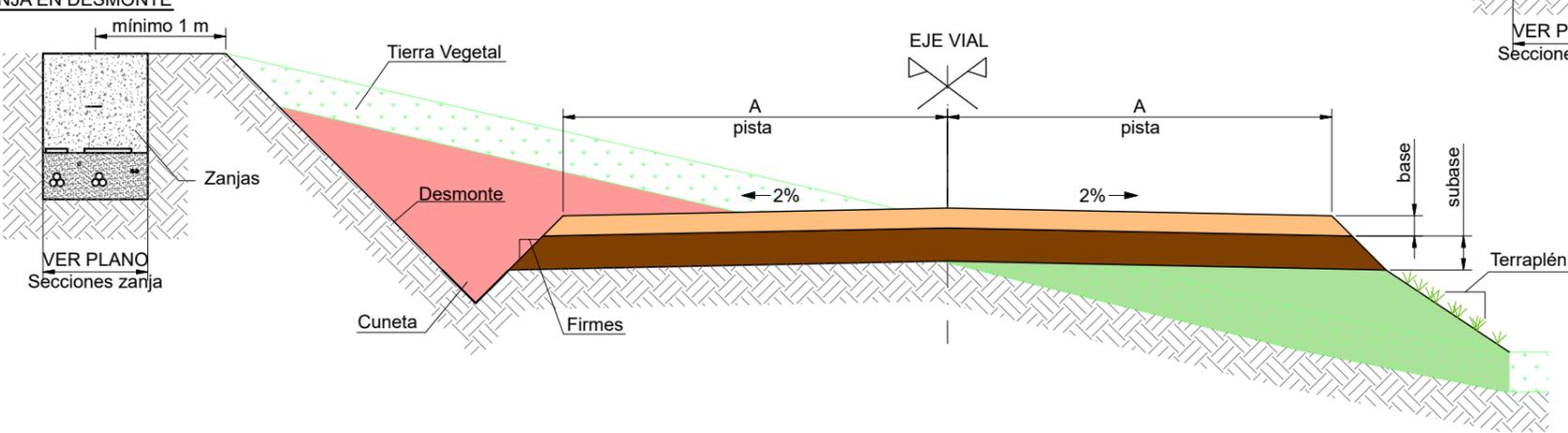
SECCION TIPO VIAL. DESMONTE Y TERRAPLÉN
