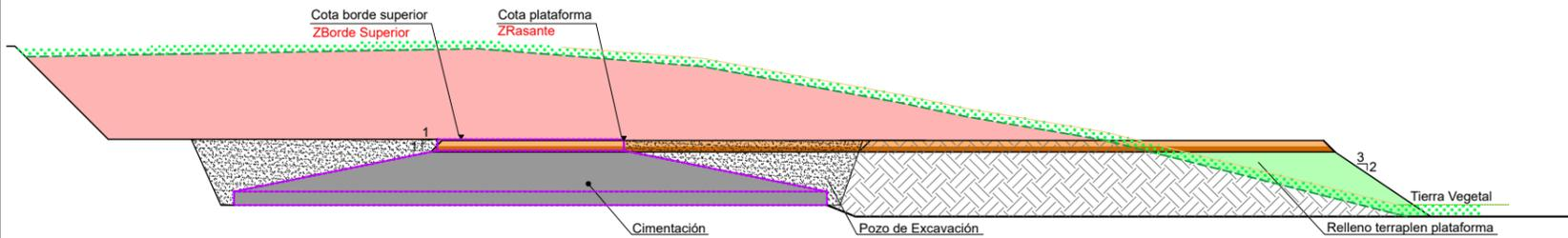
**SECCION B-B: PLATAFORMA DE MONTAJE**
