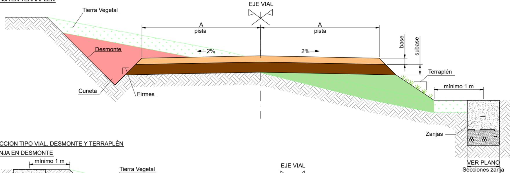
SECCION TIPO VIAL. DESMONTE Y TERRAPLÉN
