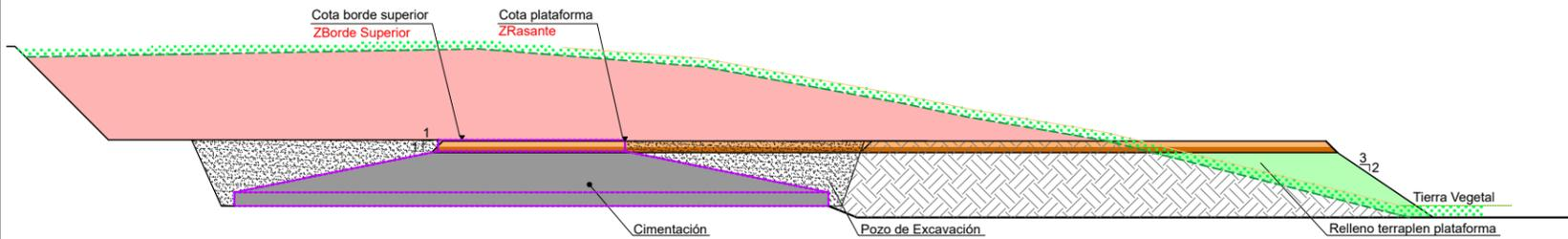
**SECCION B-B: PLATAFORMA DE MONTAJE**
