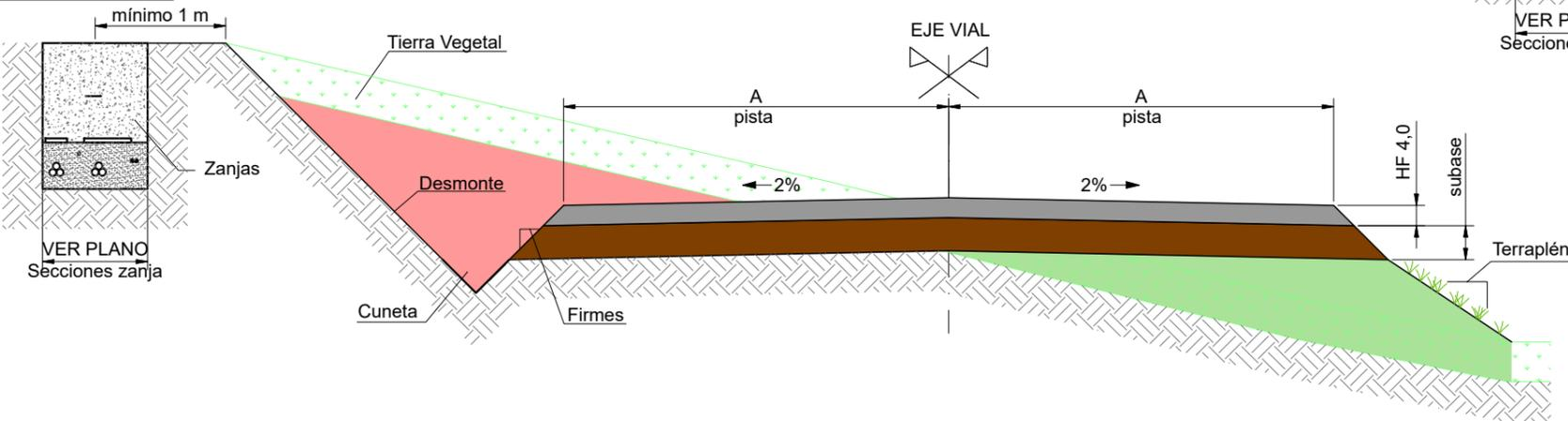
**SECCION TIPO VIAL. DESMONTE Y TERRAPLÉN**
