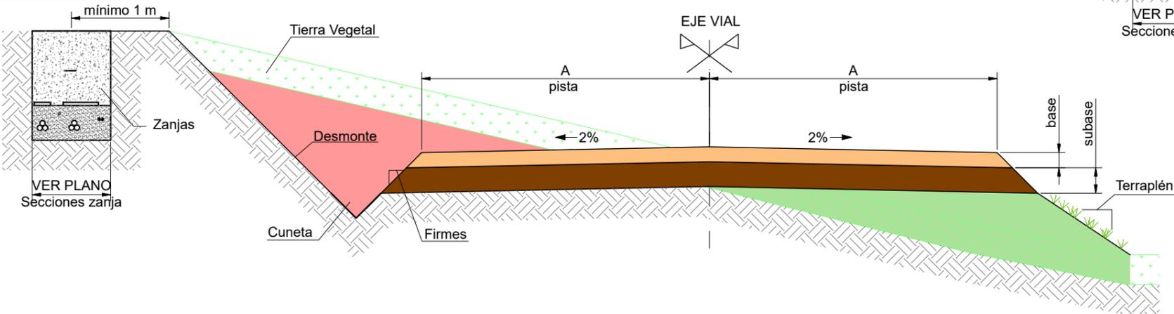
SECCION TIPO VIAL. DESMONTE Y TERRAPLÉN
