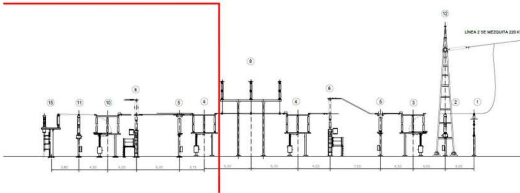
Ilustración 19. Alzado SET Seccionamiento
