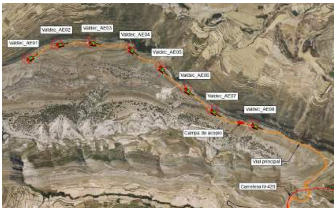
Imagen 10. Red de viales del parque eólico.
