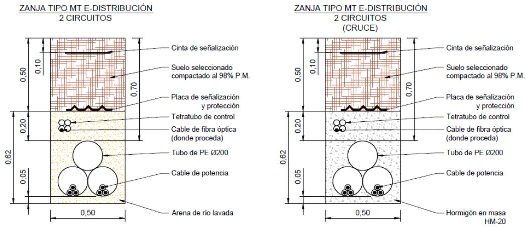
Ilustración 2. Zanja para E-S en el CS
