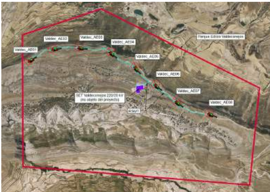
Imagen 19. Red subterránea de media tensión parque eólico.
