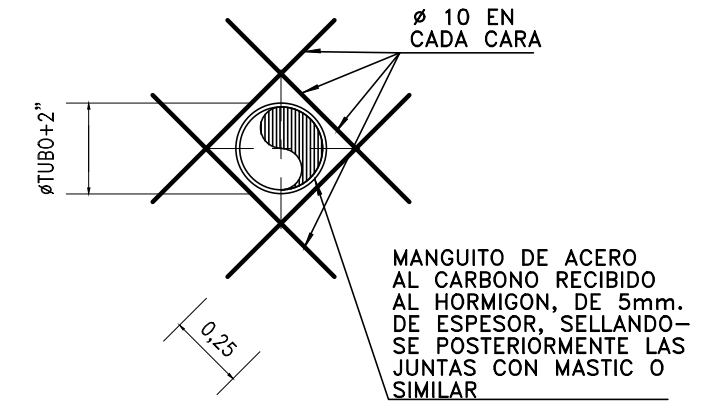
DETALLE - 2 DETALLE DE PASAMUROS S/E
