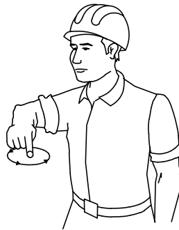
10 BAJAR LA PLUMA Y LEVANTAR LA CARGA
