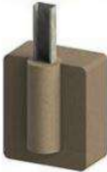
Imagen-croquis de cimentación con preperforación
