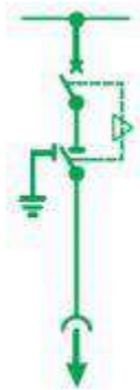
Unidad de protección del transformador
