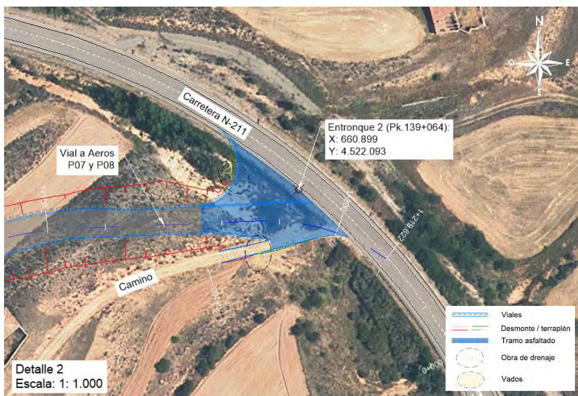
Entronque 2 con Carretera N-211
