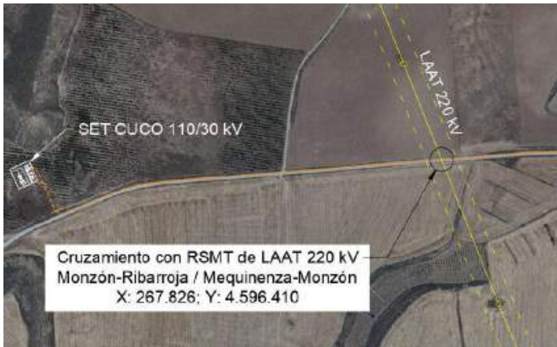
Ilustración 3: Afección a LAAT 220 kV con cruzamiento de la RSMT
