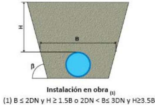
Figura 3. Esquema tipo zanja
