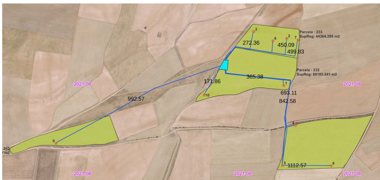
Figura 5. Parcelario, pozos y tuberías de llenado de la balsa
