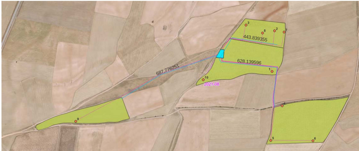
Figura 6. Parcelario, pozos y tuberías de impulsión del riego hasta inicio sectores.
