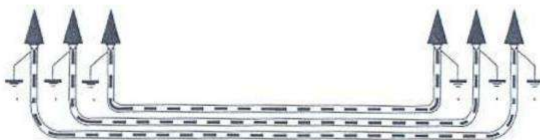
Figura 26: Puesta a tierra de cubiertas metálicas.
