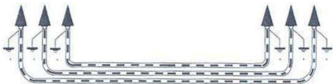
Figura 27: Puesta a tierra de cubiertas metálicas.
