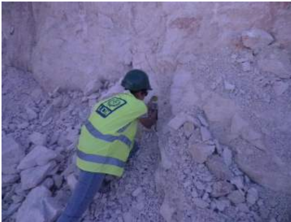
Ilustración 12. Medida de la dirección y buzamiento de discontinuidades (Fuente: LOM, 2017).
