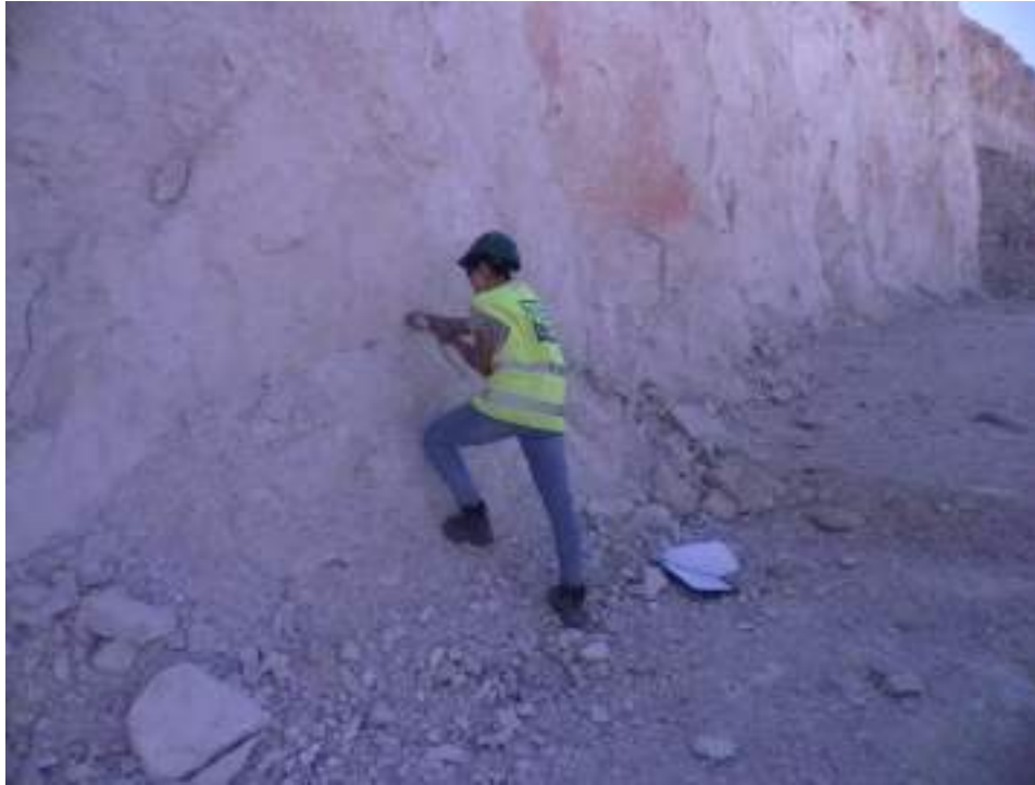
Ilustración 11. Medida del Índice de Rebote (Fuente: LOM, 2017).
