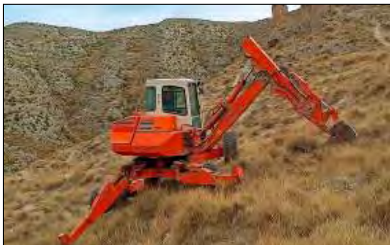
Imagen 11. Retroexcavadora tipo araña. Fuente: garmoforestal.
