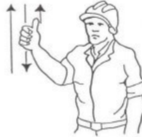
4 Levantar el aguilón o pluma lentamente
