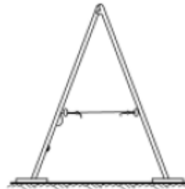
LAS ESCALERAS DE TIERRA DEBEN DISPONER DE CUERDA O CADENA Y DE ZAPATAS ANTIDESLIZANTES
