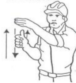
4 Levantar el aguilón o pluma lentamente
