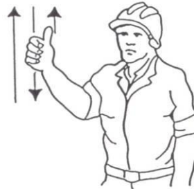
4 Levantar el aguilón o pluma lentamente
