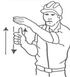
4 Levantar el aguilón o pluma lentamente
