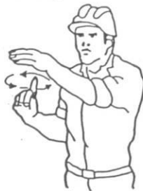
3 Levantar la carga lentamente
