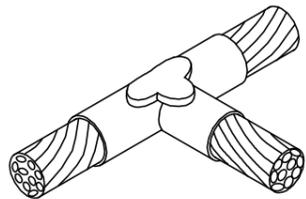
**DETALLE SOLDADURA EN CRUZ CABLE 95 MM2**
