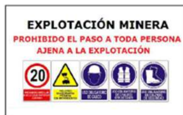
Fig Señalización de seguridad a colocar en el acceso de la explotación
