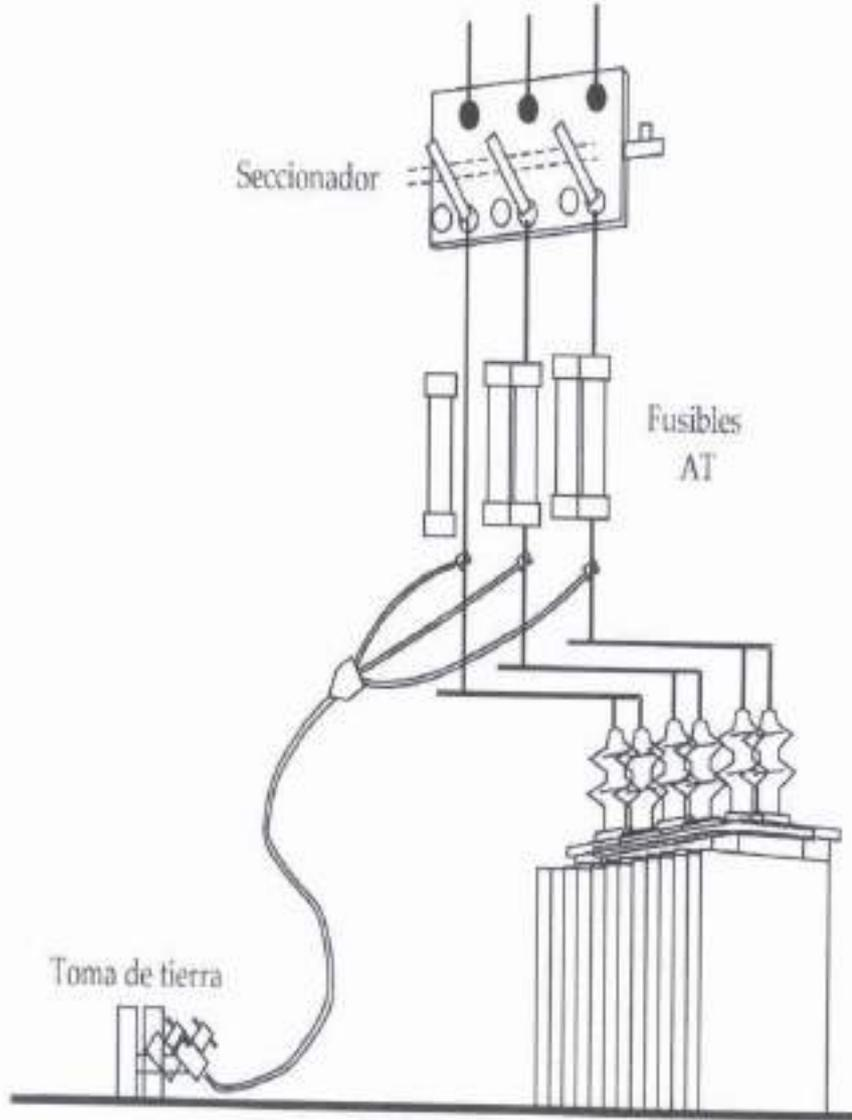
CABLES DE PUESTA A TIERRA Y EN CORTOCIRCUITO CON TRANSFORMADOR
