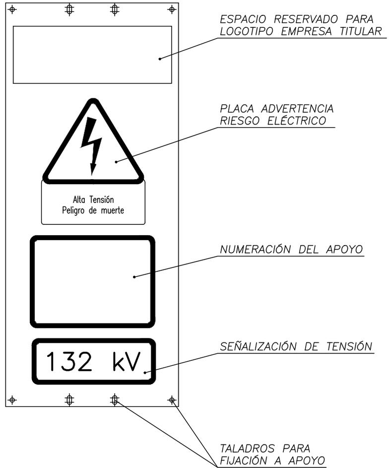
MATERIAL : CHAPA DE ACERO GALVANIZADO DE 1 mm DE ESPESOR
