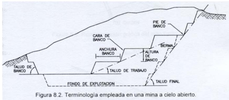
Figura 8.2. Terminología empleada en una mina a cielo abierto.
