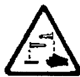
RIESGO DE CORROSION
