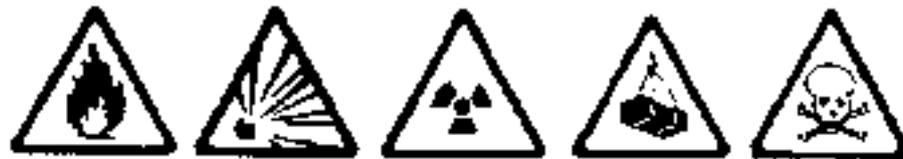
PELIGRO DE INCENDIO MATERIAL COMBUSTIBLE    PELIGRO DE ERUPCIÓN MATERIAL EXPLOSIVO    PELIGRO DE IRRADIACIÓN    PELIGRO DE SUSTANCIAS CORROSIVAS    PELIGRO DE INTOXICACIÓN
