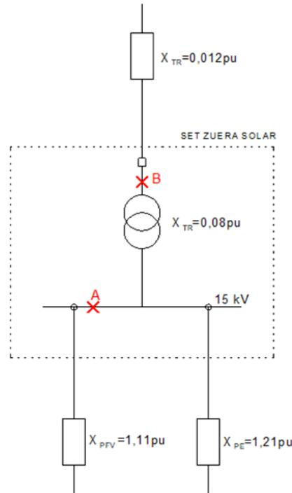
Tomando como referencia el esquema anterior se va a realizar el cálculo de la  $I_{cc}$  que soportaría en caso de falta en el punto A en estudio.
