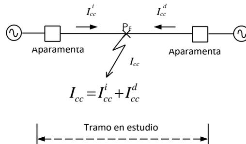
Para dimensionar los conductores y aparamenta del tramo en estudio, se debe seleccionar la mayor de  $I_{ci}^i$  y  $I_{ci}^d$ , que es la correspondiente al lado con menor impedancia, por ser el lado que aportará más intensidad en caso de falta.
