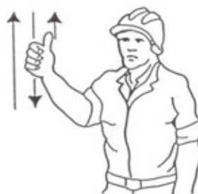
4 Levantar el aguilón o pluma lentamente
