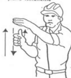
4 Levantar el aguilón o pluma lentamente
