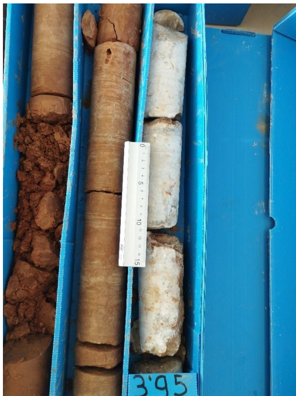
Figura 1-SD3. Nivel del yeso alabastrino del Tramo-5 dentro del Sondeo-3
