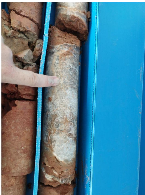
Figura 1-SD5. Vista de parte del Tramo-6 del Sondeo-5, observándose nódulos de yeso alabastrino dentro de una matriz carbonatada.
