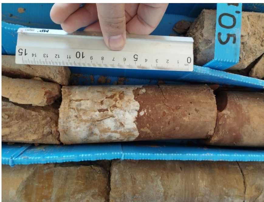
Figura 1-SD1. Vista de pequeño nivel de alabastro con textura "en turrón" dentro del Tramo-1 en el Sondeo-1.
