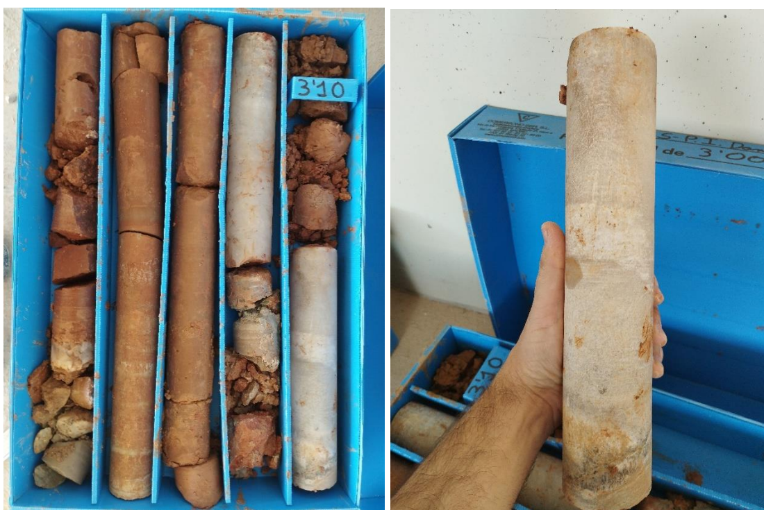
Figura 1-SD4. Diferentes vistas del nivel de yeso alabastrino que constituye el Tramo-6 dentro del Sondeo-4
