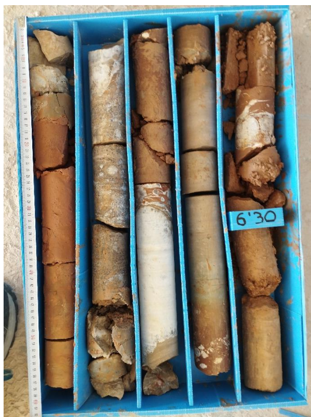
Figura. 1-SD2. Vista de la caja de sondeo nº 3 del Sondeo-2 mostrando un gran meganódulo de alabastro dentro del Tramo-8
