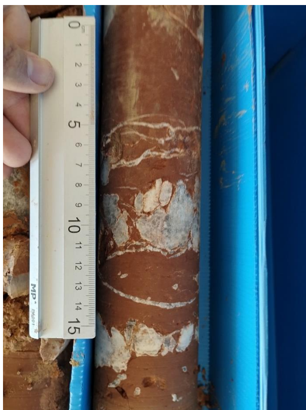
Figura 2-SD1. Nódulos de alabastro de tamaño centimétrico con textura "Chicken wire" dentro del Tramo-12 en el Sondeo-1
