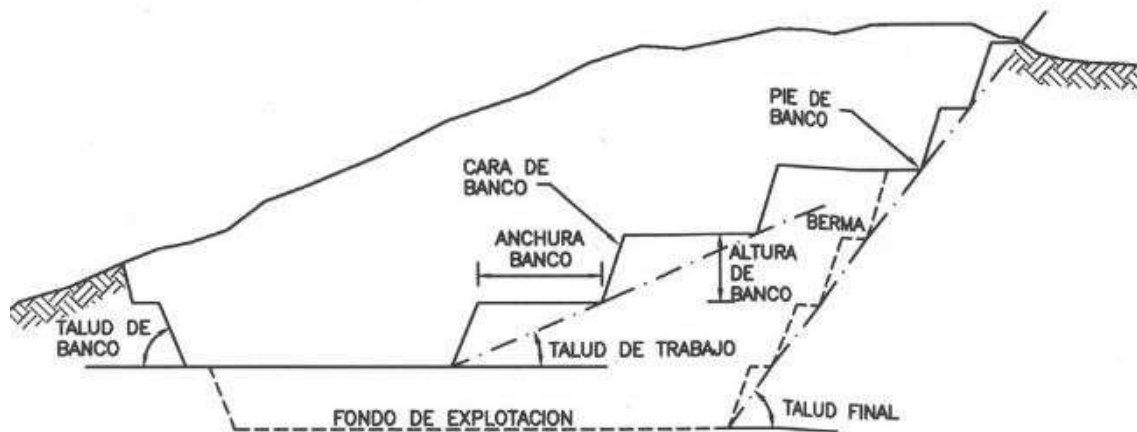
Figura. Parámetros geométricos de diseño de explotaciones (Fuente: Manual de Evolución y Diseño de Explotaciones Mineras. -M. Bustillo Revuelta, López Jimeno.).
