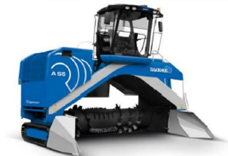
Figura 5. Maquina volteadora de compost auto propulsada
