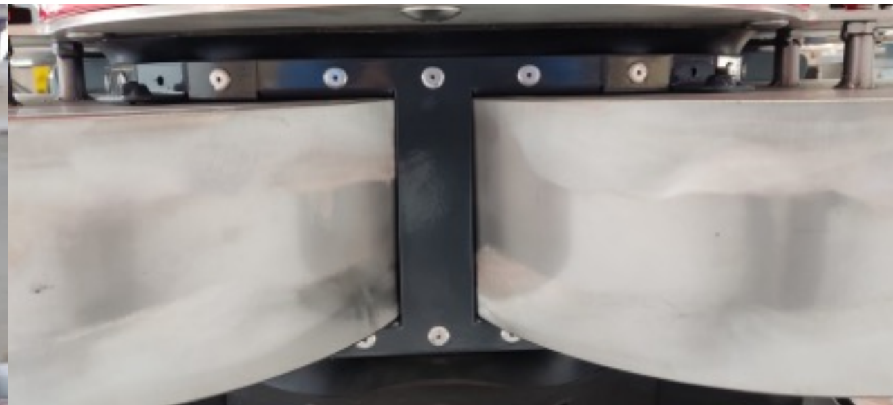
Localizador con pieza nueva para evitar la salida del grano
