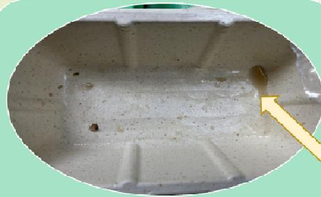
Aguantan bien la **humedad condensada en interior** (hay más recubrimiento). En el **exterior** donde no hay recubrimiento, **no hay agua**.
