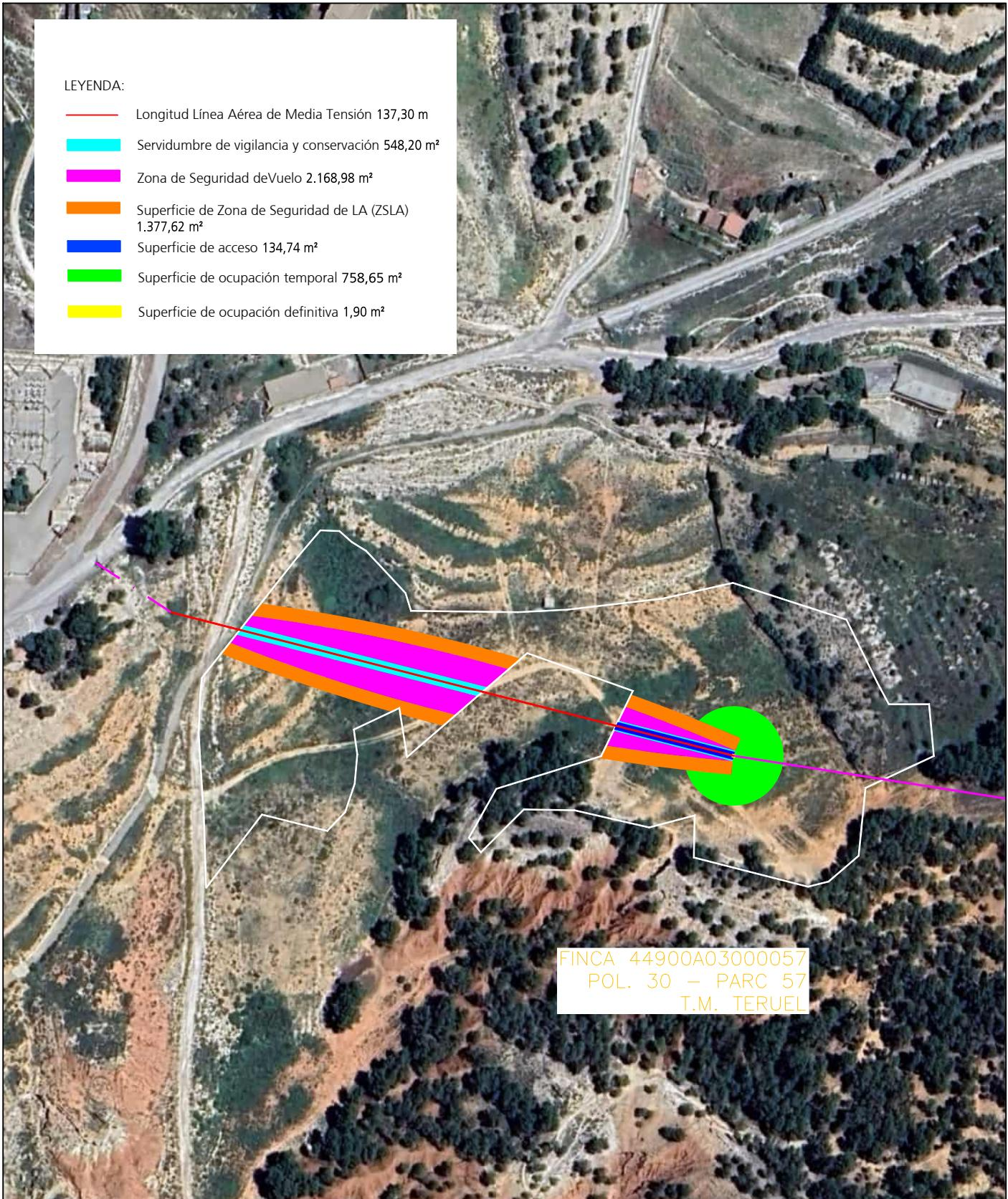
PROYECTO DE EJECUCIÓN DE REFORMA DE LAMT "CORBALAN" 20kV ENTRE LOS APOYOS EXISTENTE N°1B Y APOYO EXISTENTE N°3, CON OBJETO DE GARANTIZAR LAS DISTANCIAS CON LA NUEVA PROYECCIÓN VIAL ACCESO AL HOSPITAL DE TERUEL EN EL T.M. TERUEL (PROVINCIA DE TERUEL)
