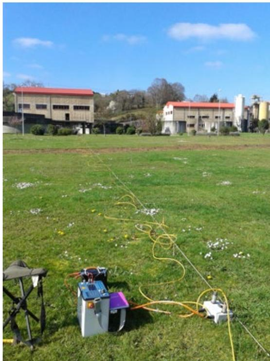
Fig. 6.- Implantación para tomografía eléctrica (ocsa-geofísica).
