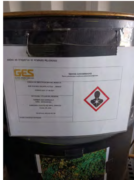
Foto 5 y 6: segregación y etiquetado de residuos peligrosos.
