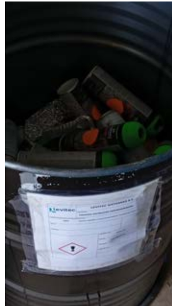
Figura 2. Residuos peligrosos mal segregados
