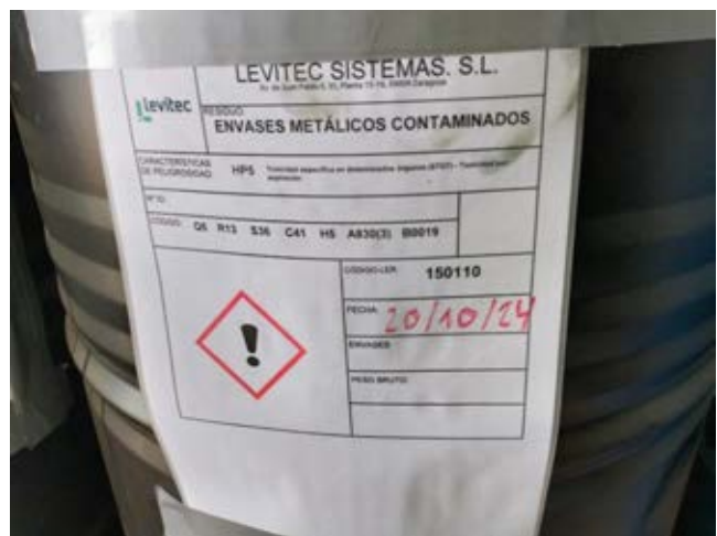
Figura 4. Etiqueta de residuos peligrosas correctamente corregida.
