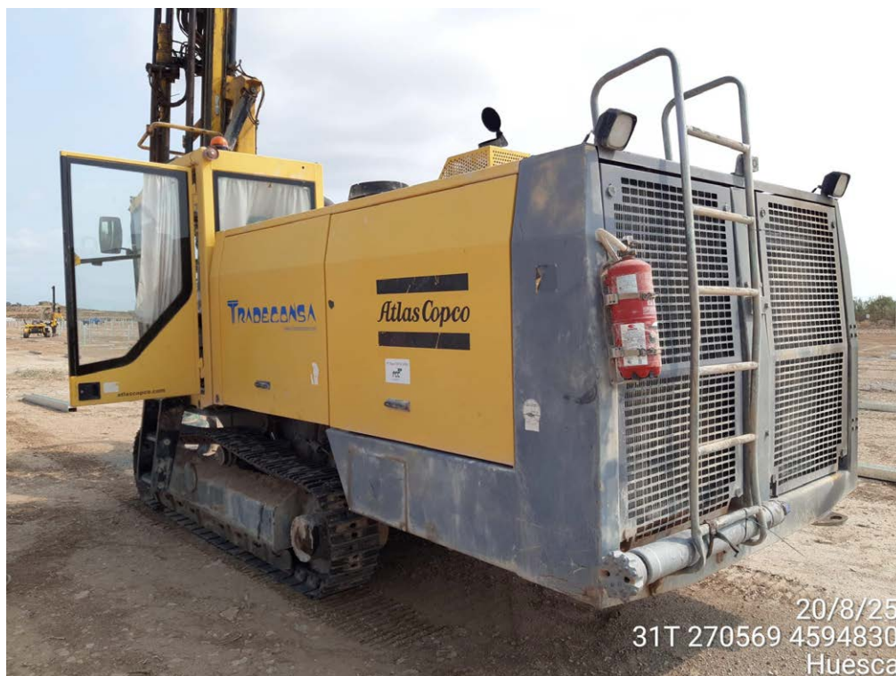
Imagen 13: Extintor en máquina perforadora.
