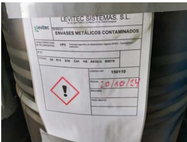
Figura 3. Etiqueta de residuos peligrosas correctamente corregida.
